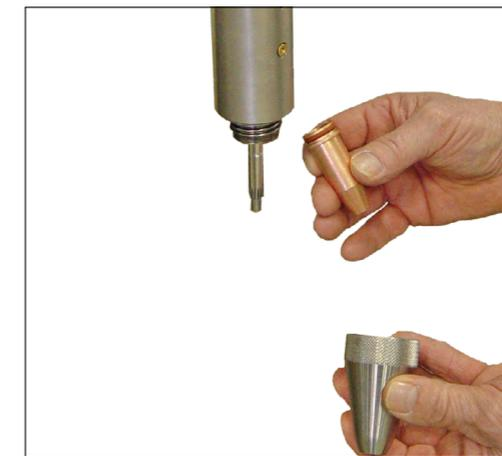
Las piezas consumibles del soplete se pueden retirar fácilmente a mano para un reemplazo rápido.
