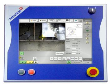
El Global Control<sup>s</sup> muestra una imagen de video de las retículas en las esquinas de la placa para su alineación y anidación.
