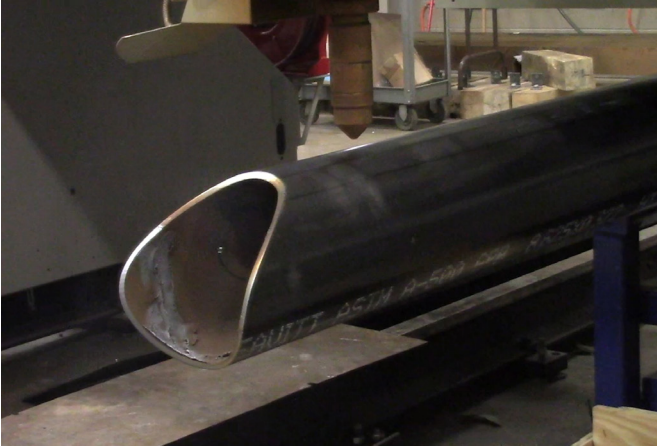
Tubo cortado en bisel con Infinity Rotator.
