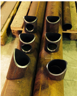
Corte con bisel en tubo redondo.
