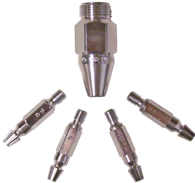
Se requieren cuatro tamaños de boquillas y ningún cambio de tuerca para cortar material de 1/4" a 3" de espesor.
