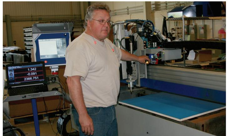
El operador coloca la bola de captura magnética en la máquina mientras que la pantalla de la computadora a la izquierda muestra mediciones en tiempo real.
