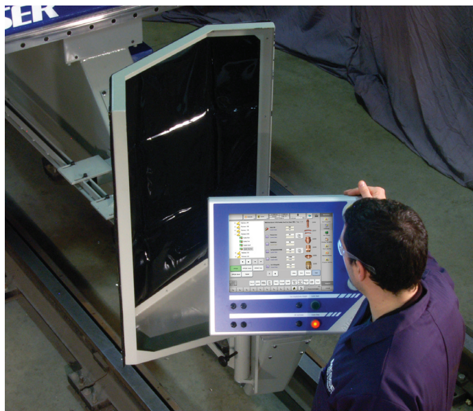
La cortina contra el brillo lateral en la estación de control brinda protección para el operador.
