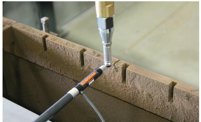
**El Ballbar tiene un extremo conectado a la punta del soplete de corte y el otro extremo a la base fija. Se ordena a la máquina trazar dos círculos a varias velocidades de corte mientras la interfaz recolecta datos del transductor. Después de que se recolectan los datos, el software calculará y plasmará los resultados para su análisis.**
